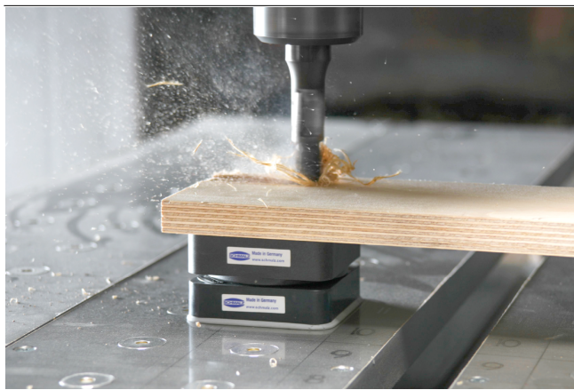
Присоска и Mono-Base Innospann при зажиме деревянной заготовки
